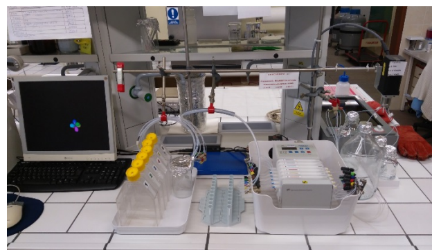
Obr. 1 Automatická jednotka pro preparaci mikrovzorků pomocí metody AAA.
